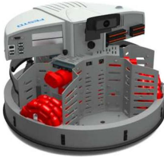
**Figura 6.1.** Plataforma de desarrollo para robótica móvil Festo Robotino [2].
