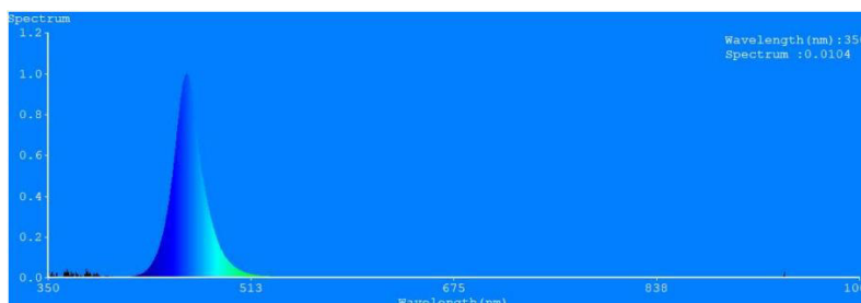
Figura 16. Distribución espectral de fuente de iluminación aro LED.
