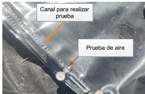
Figura 3. Prueba de aire en geomembrana en un canal dejado por el sellador de cuña. Fuente: Elaboración propia.
