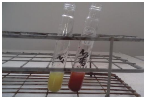
Figura 16. Prueba de cloruros en M2. De izquierda a derecha: M2 sin diluir, M2 dilución 1:10. Fuente: Archivo.
