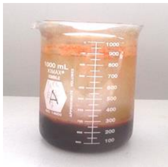
Figura 17. Prueba A. \text{Fe}^{3+} y \text{Fe}(\text{OH})_3 suspendidos en el agua. Fuente: Archivo.
