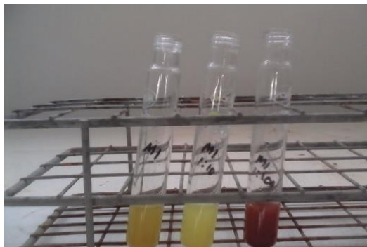
Figura 13. Prueba de cloruros en M1. De izquierda a derecha: M1 sin diluir, M1 dilución 1:10, M1 dilución 1:100. Fuente: Archivo propio.
