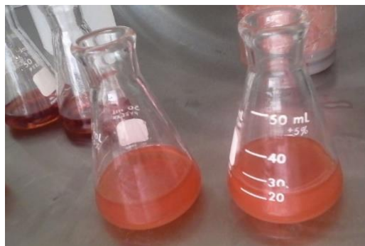
Figura 14. Interferencia por cloruros en la determinación de la DQO en M1. Fuente: Archivo propio.
