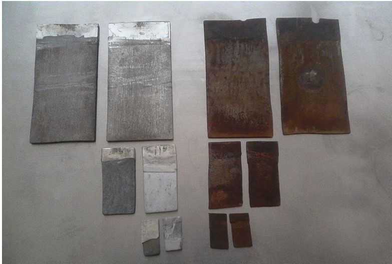
Figura 10. Diferentes tamaños de electrodos después de las pruebas de electrocoagulación. Fuente: Archivo propio.
