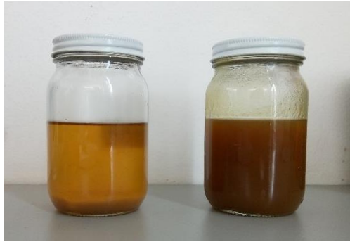
Figura 5.10 Aceites de hidrocarburos de PP. Muestra a 400°C (izquierda) y a 450°C (derecha).
