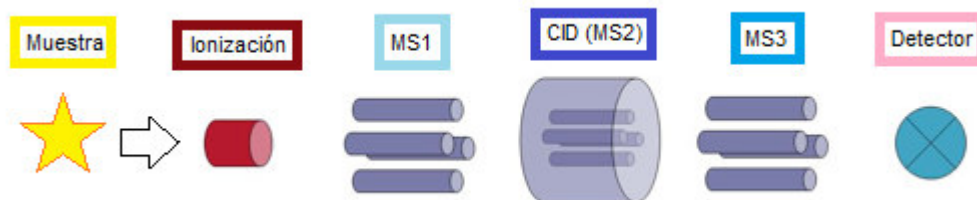
Figura 7. Esquema general de un espectrómetro de masas en tándem espacial. (MS 1 primer cuadrupolo separador de masas, CID, MS 3 segundo cuadrupolo separador de masas) [94] .
