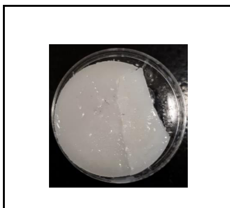
Figura 48. Matriz basada en el entrecruzamiento de un microemulsión PDMS-OH/Surfactante/Agua (Sistema 3)
