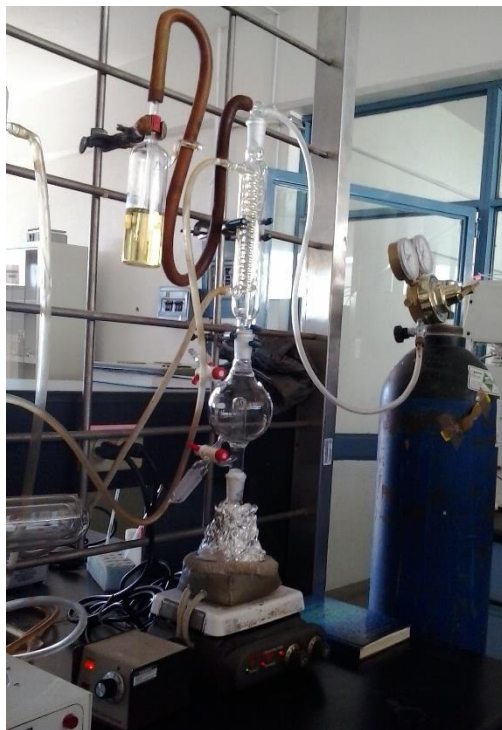
Figura II. 15. Sistema de destilación para Pip y DCM. La cobertura de aluminio permite homogeneizar el calentamiento.
