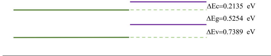
FIGURA 3.5: Alineamiento de bandas mediante potencial electrostático para la interfaz \text{Al}_{0.5}\text{Ga}_{0.5}\text{As}/\text{GaAs} de 24 capas atómicas. Para los demás sistemas se presenta un alineamiento similar, siendo la principal diferencial \Delta E_g y cuyos valores de desajuste de banda de valencia y conducción se observan en la Tabla (3.3).
