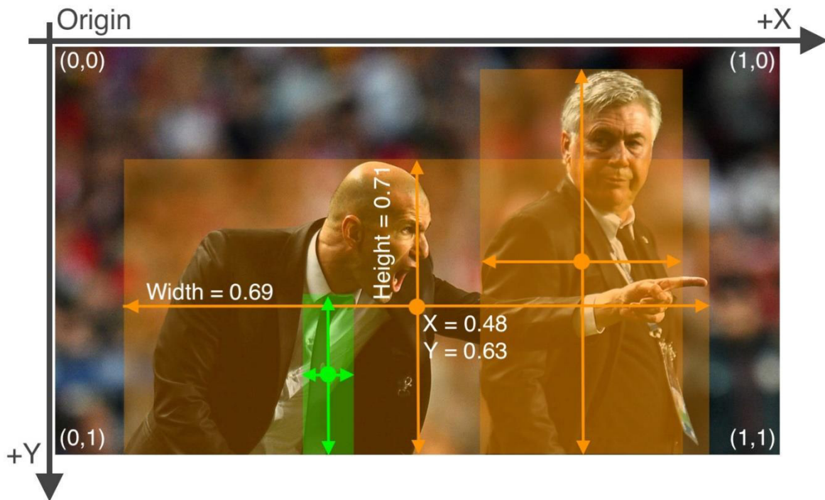
Figura 18. Ejemplo de los valores que toma la etiqueta YOLO, para formarse. Fuente: [57]
