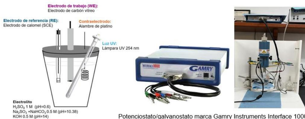
Figura 33. Configuración del sistema electroquímico.
