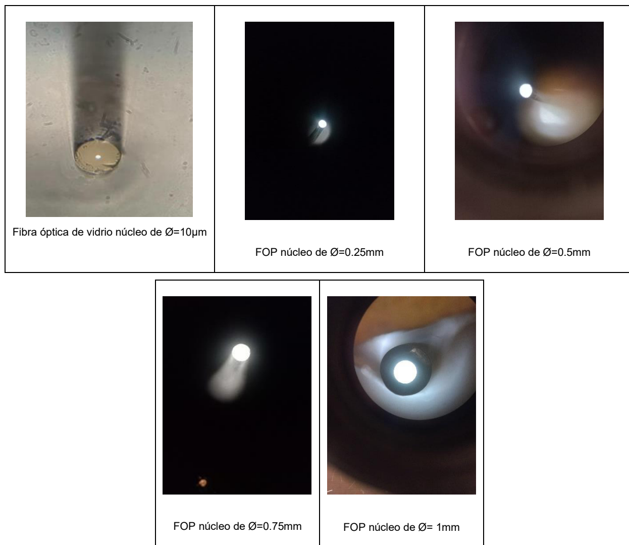
Figura 12. Comparación del núcleo de vidrio con el núcleo de las FOP.
