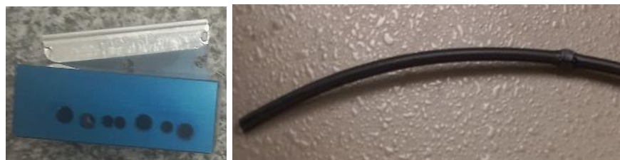
Figura 23. Cortador de fibra óptica y segmento de FOP.
