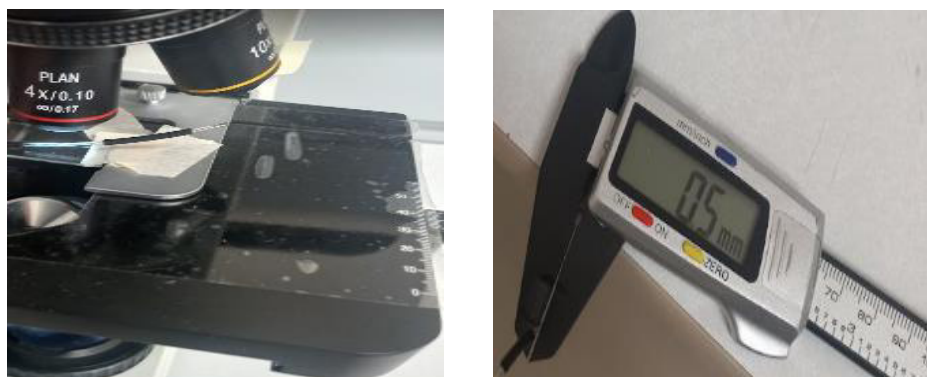
Figura 29. Instrumentos utilizados para observar y medir el desbaste.
