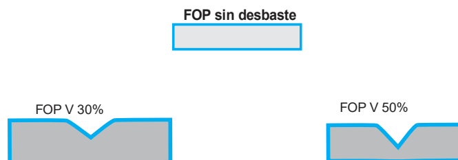
Figura 31. FOP con desbaste diametral en V a diferentes porcentajes.
