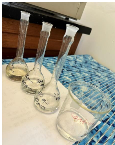
Figura 3. Capacidad de saturación del RC mediante adiciones de solución de níquel, 20 ppm y pH 4.
