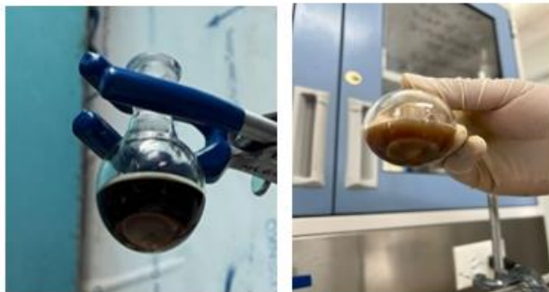
Imagen 3: Vista de reacción antes y después de la cianoeterificación de lignina
