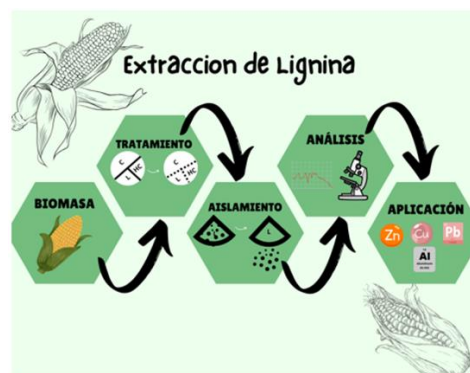
Figura 3: Esquema general de extracción y caracterización de la lignina. (Elaboración propia, 2024)
