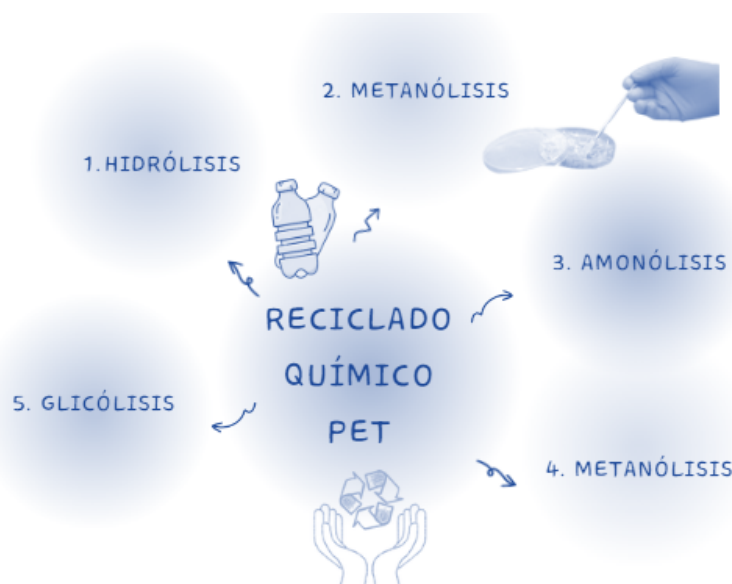
Imagen 1. Tipos de degradación química por solvólisis.
