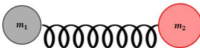
Figura 2.21. Representación del enlace como un “resorte” que mantiene unidos a dos átomos.
