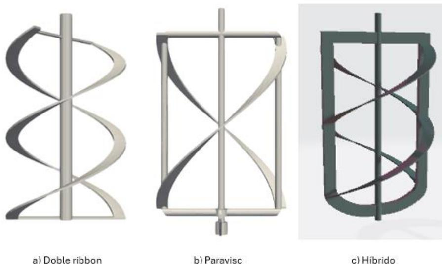
Figura 1. Dibujo en CAD de los tres diferentes agitadores, el inciso a muestra el dibujo en CAD del agitador ribbon; el inciso b muestra el dibujo en CAD del agitador Paravisc y finalmente el inciso c muestra el dibujo en CAD del agitador Híbrido.
