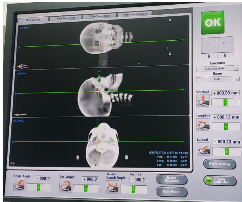
Figura 8. Imágenes DRR del maniquí de cráneo indicando el posicionamiento y las correcciones finales. Fuente: Elaboración propia.
