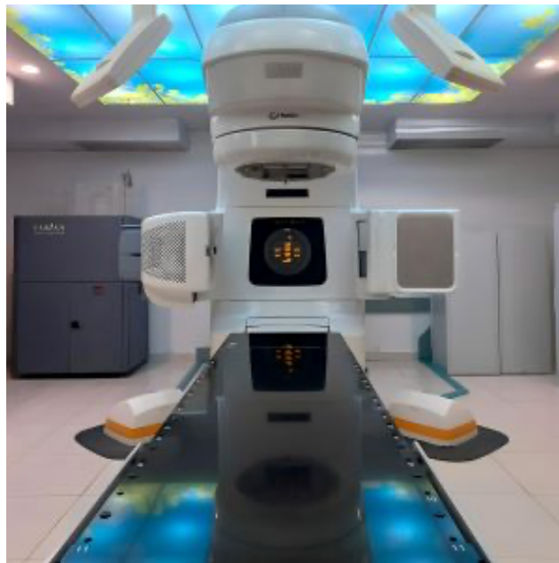
Figura 1. Sistema de radioterapia guiada por imagen Brainlab Exactrac X-ray 6D del Centro de Radioterapia Siglo XXI, que se compone de dos tubos de rayos X y dos detectores de panel plano. Fuente: Elaboración propia.
