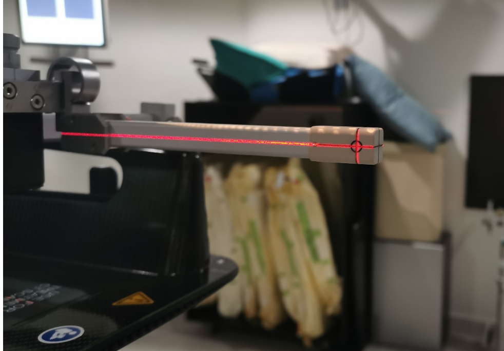
Figura 4. Posicionamiento con el láser de la sala para realizar la prueba de Winston Lutz. Fuente: Elaboración propia.
