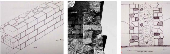
Izquierda: Figura 13. Muro compuesto por sillares y piedra irregular de cantería.<sup>149</sup>
