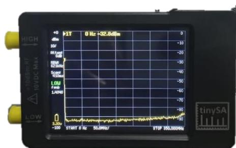
Fig. 3.9. Analizador de espectros, marca tinySA® [15]
