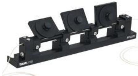
Fig.3.4 Placa controladora de polarización (PC) FPC560,  $\lambda/4, \lambda/2, \lambda/4$ , marca Thorlabs ® [9]
