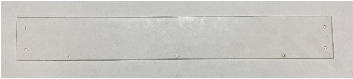
Figura 49. Lámina de acrílico que se instala en la parte frontal de la pista (medio de autoensamblaje).
