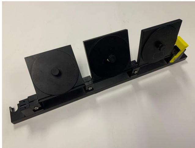
Figura 3.4: Placas controladoras de polarización manuales de Thorlabs.
