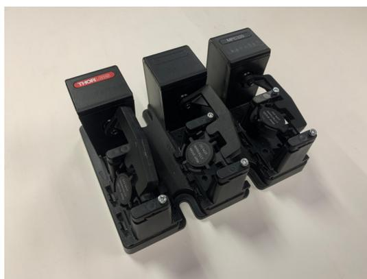
Figura 3.6: Placas controladoras de polarización motorizadas de Thorlabs.
