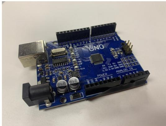
Figura 3.16: Microcontrolador Arduino UNO para controlar el movimiento de las placas controladoras de polarización.
