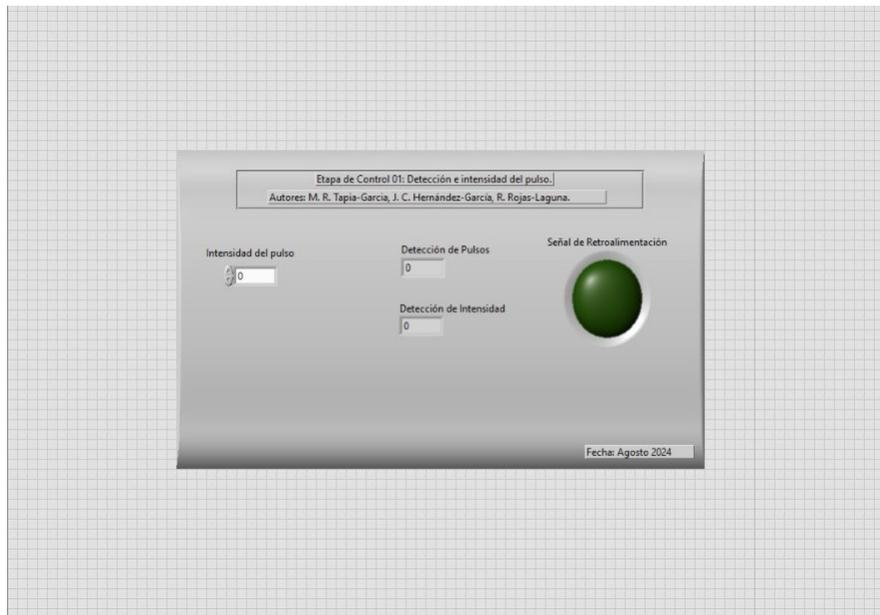
Figura 3.15: Interfaz en LabVIEW para la detección de la amplitud de pulsos.
