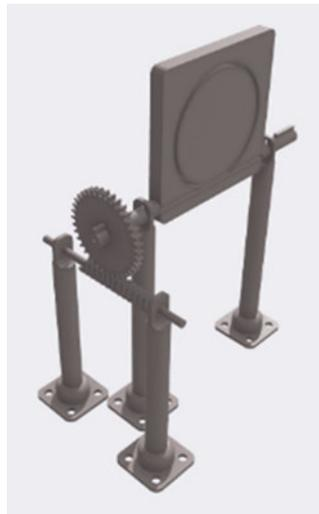
Figura 3.7: Prototipo de placas controladoras de polarización (Versión 1).
