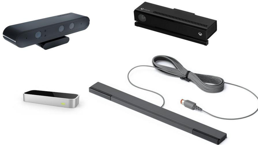
Fig. 47. Izq. a der. (arriba) Orbbec Astra Pro, Microsoft Kinect, (abajo) Leap Motion sensor y Nintendo Wii Sensor Bar (genérica).
