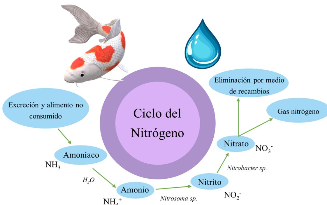
**Figura 4.** Ciclo del nitrógeno en un sistema acuícola, elaborado con información de Somerville et al., 2014<sup>(47)</sup>.
