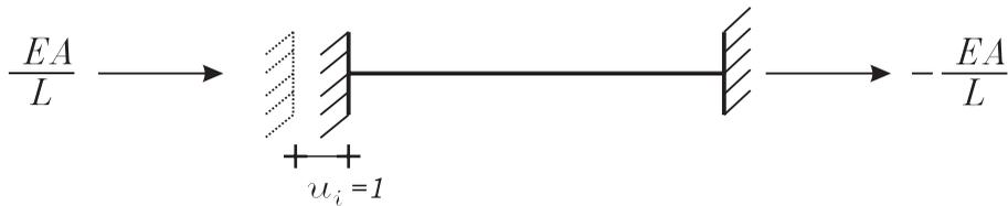
Figura 2.4 Fuerzas generadas por el desplazamiento unitario en el nodo  $i$
