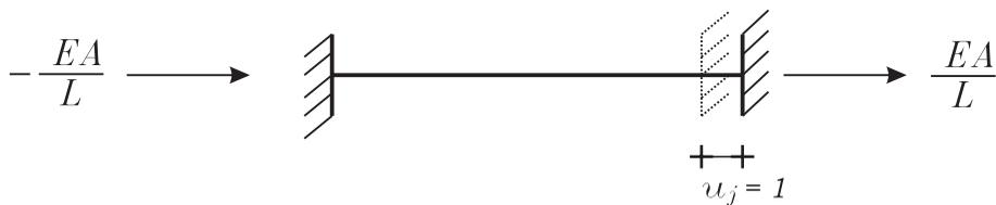
Figura 2.5 Fuerzas generadas por el desplazamiento unitario en el nodo  $j$
