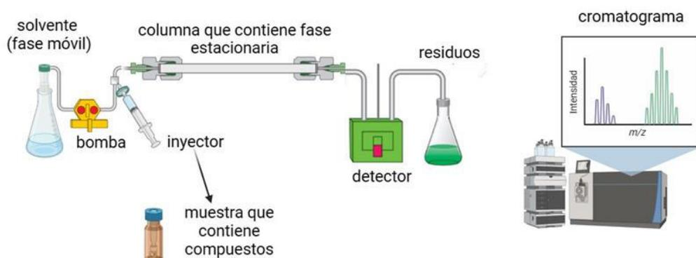
**Figura 4.** Esquema de la determinación de componentes de los edulcorantes mediante espectrometría de masas. Creado con BioRender.com.
