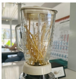
Figura 10. Trituración de rastrojo de trigo en la licuadora
