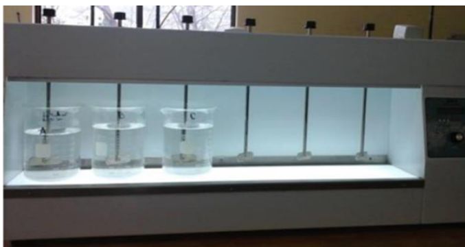
Figura 2.3 Sistema empleado para la prueba de jarras.
