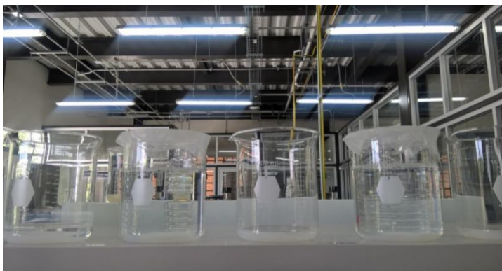
Figura 2.4. Maduración de los flóculos en vasos de precipitado con capacidad de 1L para análisis fisicoquímicos.
