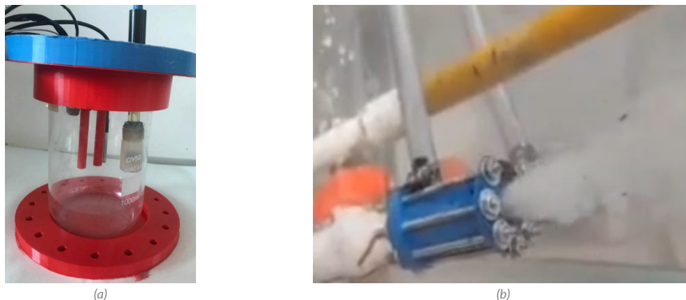
Figura 3. Prototipos en impresión 3D. (a) Prototipo final de reactor. (b) Prototipo final de microburbuja.
