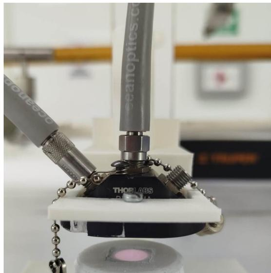
FIGURA 3.4: Arreglo óptico en modo reflectancia, donde la fuente de luz se posiciona a  $90^\circ$  y la fibra colectora a  $45^\circ$  respecto a la muestra. En esta imagen, la muestra es sulfato de bario, y se observa el haz puntual de iluminación y la región de recolección espectral. *Foto propia.*
