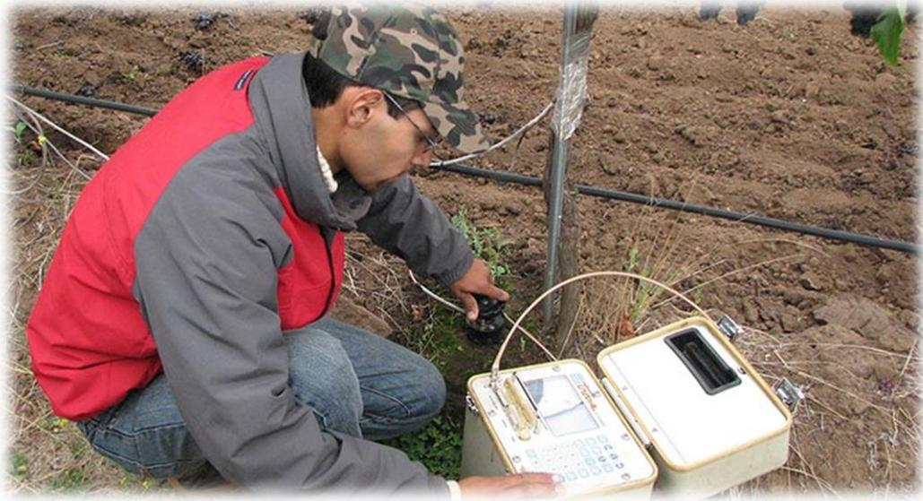
Ilustración 40: Verificación en campo de condiciones de humedad residual
