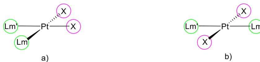
**Figura 10.** Fórmula estructural general de complejos de tipo a) *cis*-[PtX<sub>2</sub>(L<sub>m</sub>)(L<sub>m</sub>')] y b) *trans*-[PtX<sub>2</sub>(L<sub>m</sub>)(L<sub>m</sub>')] con X: I o Cl, mientras que (L<sub>m</sub>) y (L<sub>m</sub>') son ligantes monodentados distintos entre sí.
