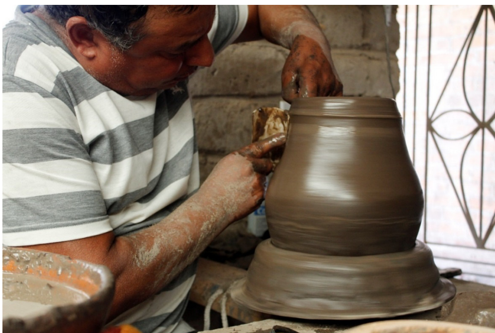
Ilustración 13. Mediante herramientas adaptadas por el artesano comienza a dar forma a la olla. Fotografía de Angel Zavala Serrano.
