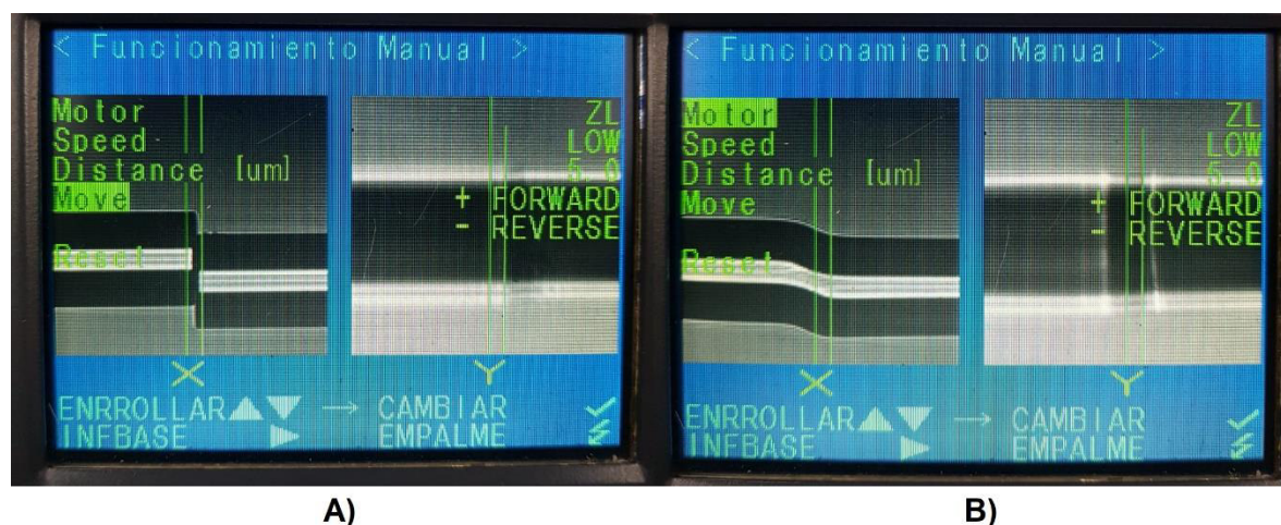
Fig 3.11.- Proceso de fabricación de los MZI con el método Core-offset.
