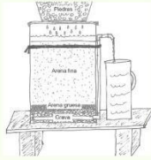
Filtro de Bio-Arena
