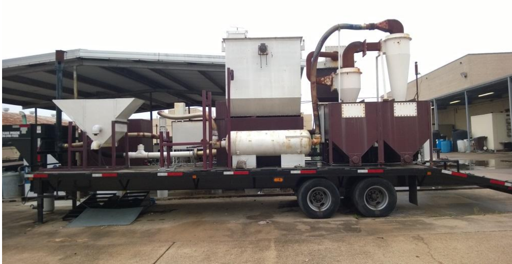
Figura. 3.4. Sistema de gasificación piloto en la Universidad de Texas A&M [82].
