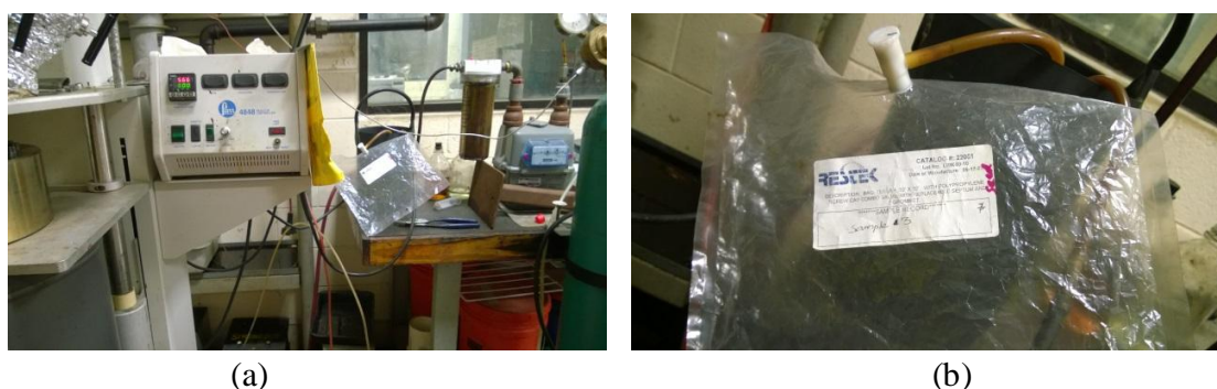
Figura 7.35. Sistema de colección de muestras de gas de síntesis (a) ubicación y (b) bolsa TEDLAR de 3 litros.
