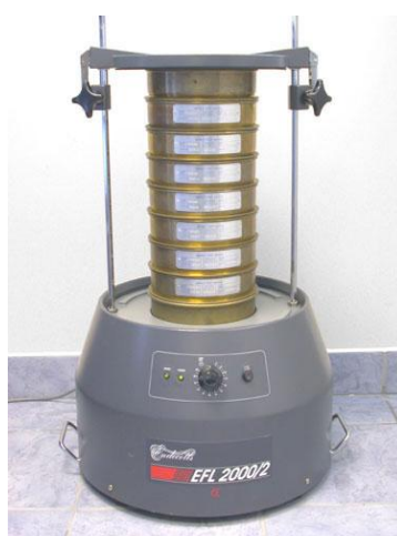
Figura 2.9. Tamizador usado para establecer grupos de partículas en diferentes tamaños.
