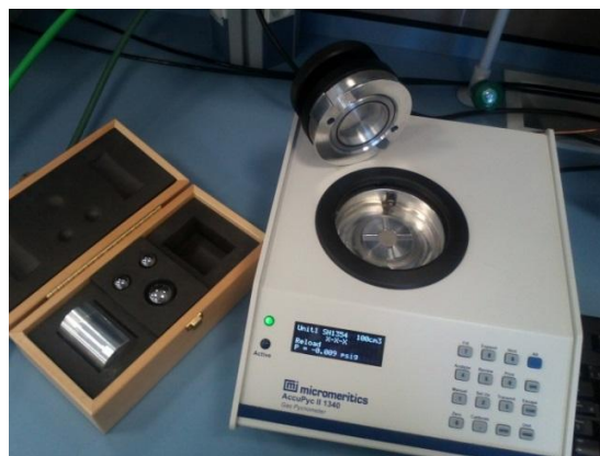
Figura 2.8. Picnómetro usado para medir la densidad de las partículas de biomasa.
