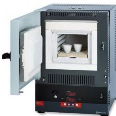
Figura 2.11. Horno usado para medir el contenido de materia volátil en el combustible
