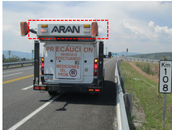
Figura 25. Cámaras monocromáticas montadas en la parte posterior del vehículo ARAN.
