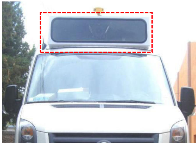
Figura 24. Cámara panorámica montada en la parte frontal superior del vehículo ARAN.
