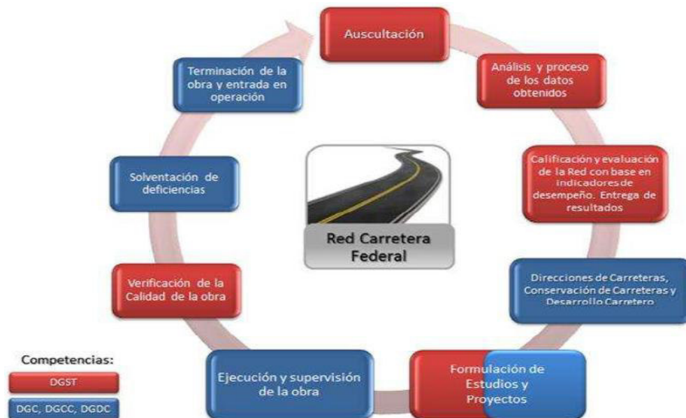
Figura 8. Ciclo de etapas para atender la conservación de carreteras.
