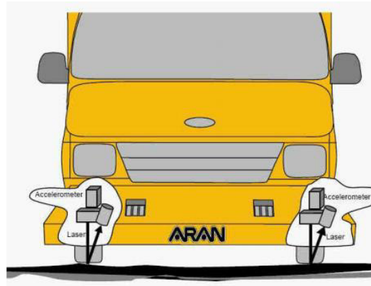
Figura 20. Localización de los Láseres y acelerómetros en la parte frontal del vehículo. Fuente: (Societa Italiana Progetto Manutenzione. Siproma Argentina S.A. de C.V.).
