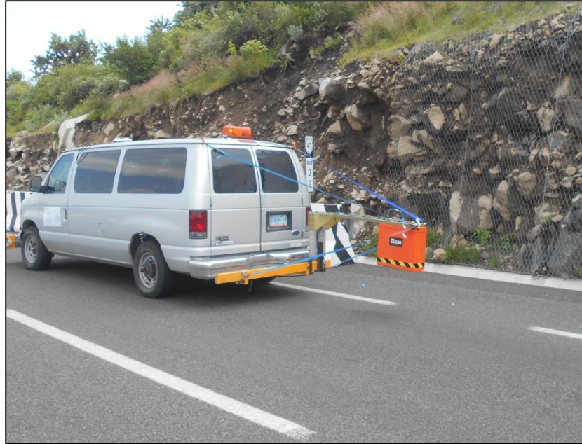
Figura 26. Antena de geo-radar montada en la parte posterior de una camioneta tipo “Van”
