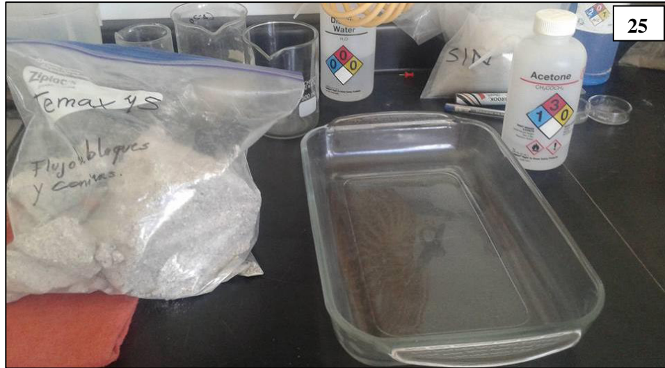
Figura 25. Refractario en el que se coloca la muestra, para ser introducida en el horno de secado.
