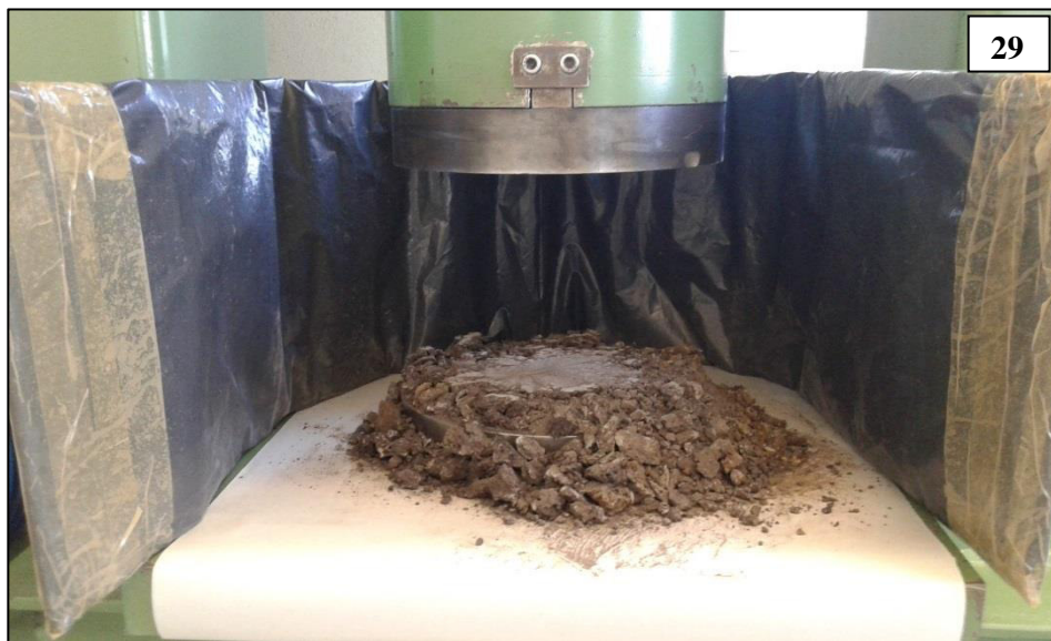
Figura 29. Muestra de roca triturada bajo el pistón compresor.
