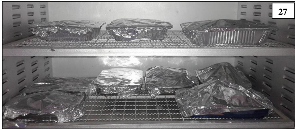
Figura 27. Muestras dentro del horno, para ser deshidratadas en su totalidad a 90°C.
