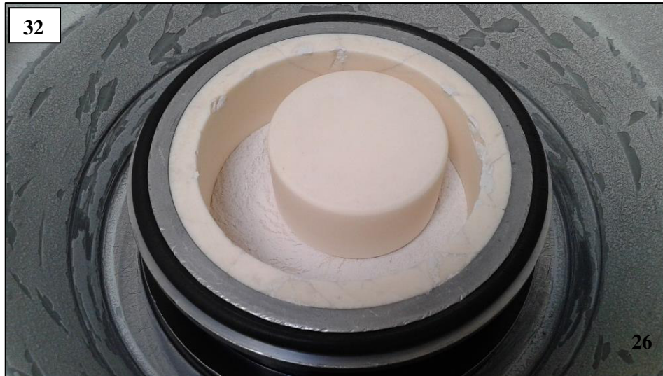
Figura 32. Molino con pulverizado de arena sílica ( \text{SiO}_2 ).
