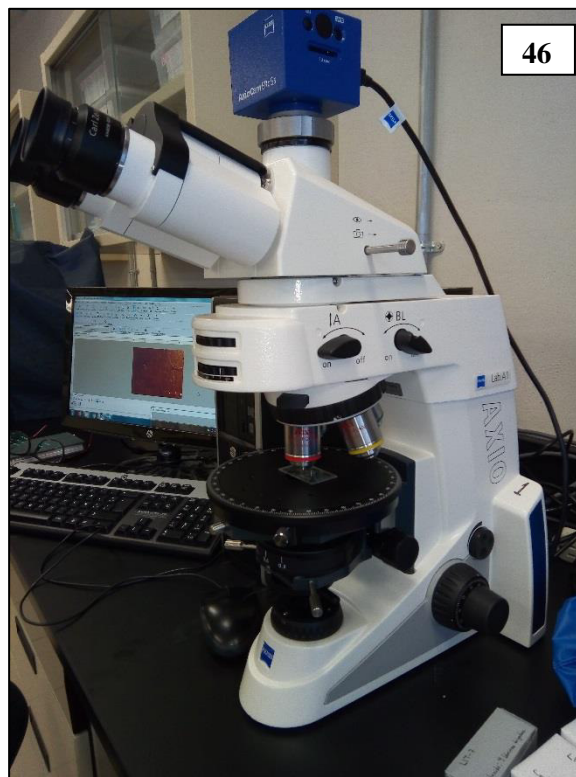
Figura 46. Microscopio de la marca ZEISS junto con la cámara y equipo de cómputo, adaptado para poder adquirir fotomicrografías.
