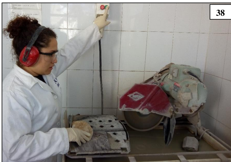
Figura 38. Corte inicial de la roca, en la sierra con disco de 12in.
