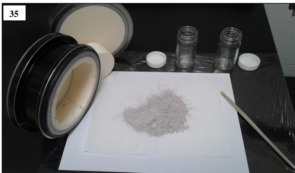
Figura 35. Plástico adherible, hoja de máquina, papel de china, pincel para retirar los residuos de muestra pulverizada, frascos en los que se colocó cada muestra y muestra pulverizada a 200 mallas, sobre papel de china.
