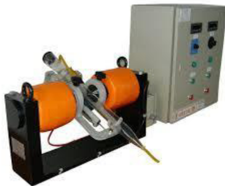
Figura 4.7. Tubo de Davis, concentrador magnético de minerales.
