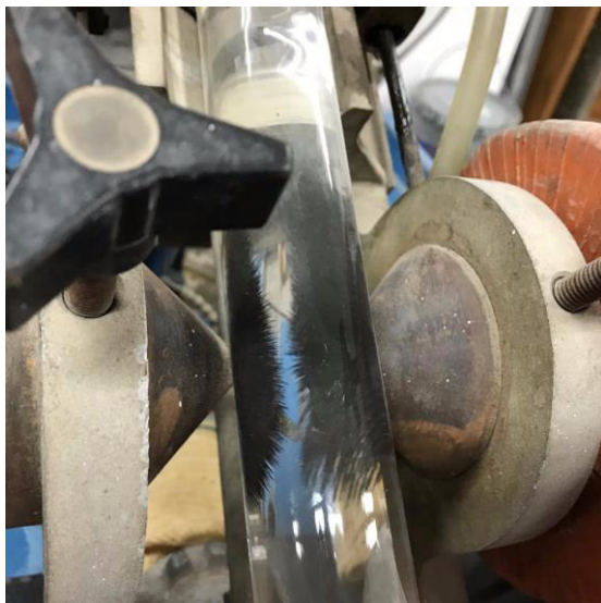
Figura 4.8. (a). Magnetita sintetizada recuperada con un imán, (b) \text{MS-N}_3\text{-Fe}_3\text{O}_4 recuperada con un imán, (c) Magnetita concentrada en el tubo de Davis y (d) \text{MS-N}_3\text{-Fe}_3\text{O}_4 concentrada en el tubo de Davis.
