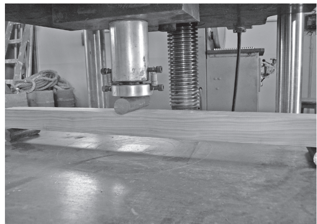
Figura 4. Probeta de madera de 50x50x760 mm empleada en la resistencia a flexión en tres puntos.
