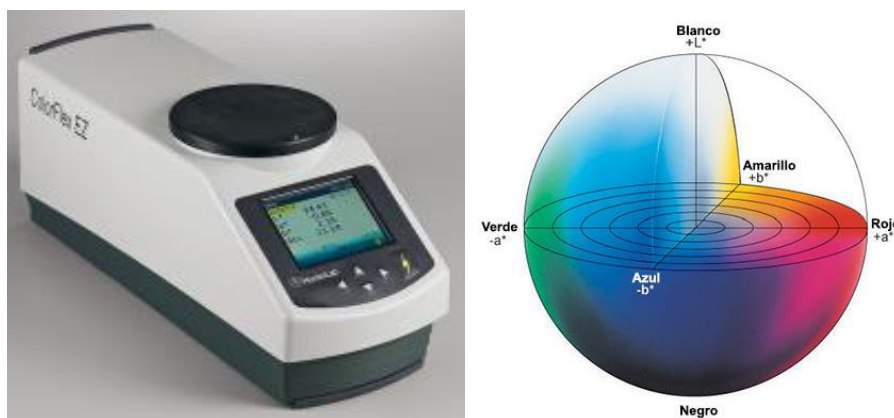
Figura 3 Color Flex EZ (modelo CFE20483 Hunter Lab, Estados Unidos) y espacio de color (CIELAB).
