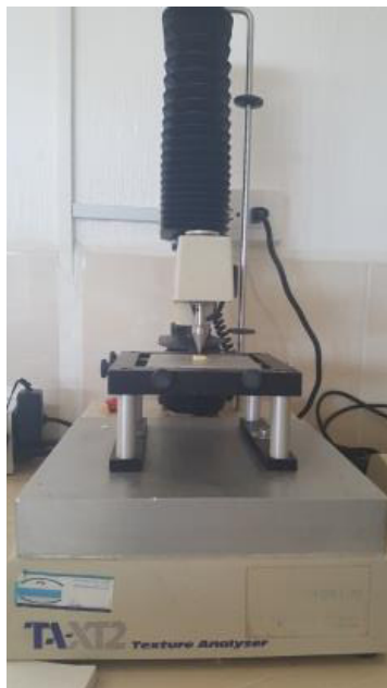
Figura 4. Analizador de textura (TA-XT2, Estados Unidos)
