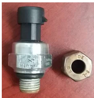
Figura 8. Sensor de presión, empaque y tuerca.
