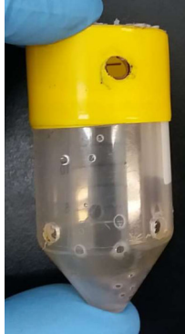
Figura 6. Filtro interno para el reactor hecho a partir de un tubo cónico.
