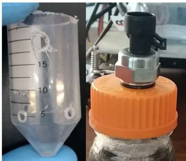
Figura 3. Sistema digester-filtro construido a partir de frasco de laboratorio.
