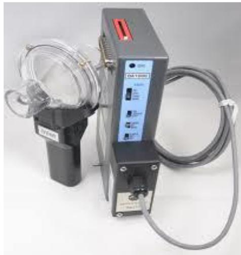
Figura 36. Neumotacómetro TSD117. Autor: Propio.
