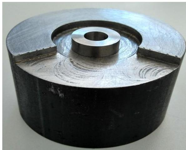
**Figura 28. Montaje de la probeta de anillo.**
