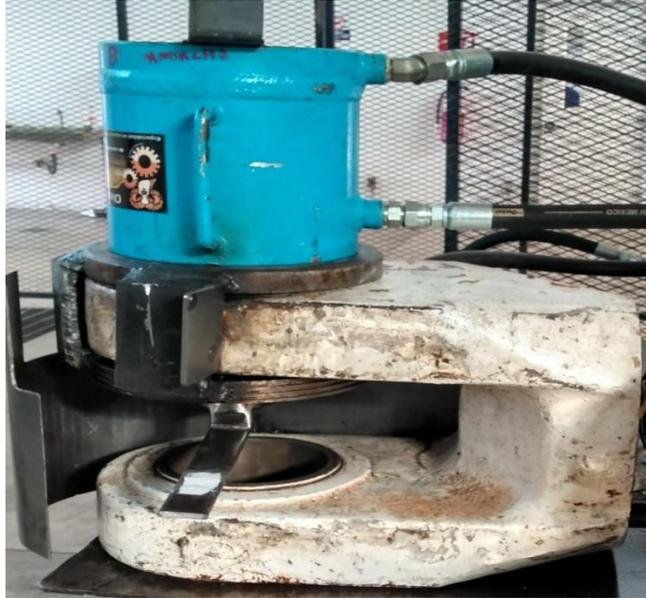
**Figura 13. Adecuación de placa para medición de desplazamiento.**
