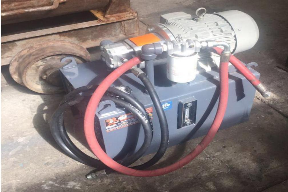
**Figura 9. Fuente de potencia hidráulica.**
