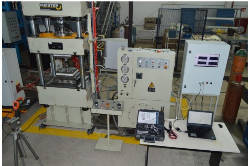
**Figura 3. Prensa YL\_100 instrumentada para pruebas de compresión [18].**
