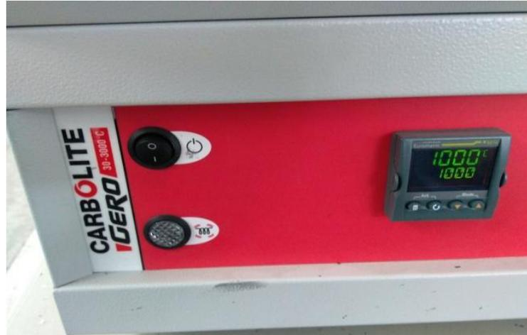
Figura 18. Calentamiento de las probetas cilíndricas hasta 1000°C.
