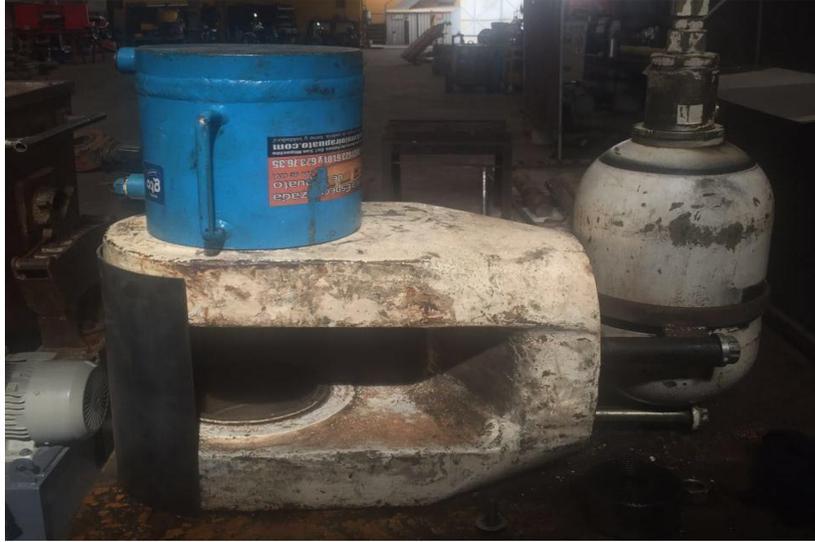
**Figura 11. Base estructural del prototipo, actuador y acumulador.**
