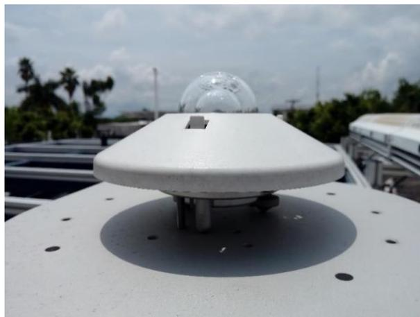
**Figura 2.7** Piranómetro CMP6
