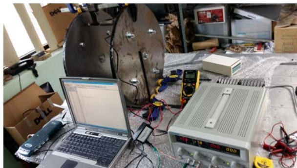
IMAGEN 8: Sistema experimental para medir el campo magnético.
