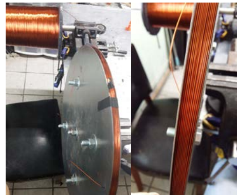
IMAGEN 5: A la izquierda se muestra el arreglo empleado para realizar el embobinado. A la derecha se muestra el resultado final del embobinado.
