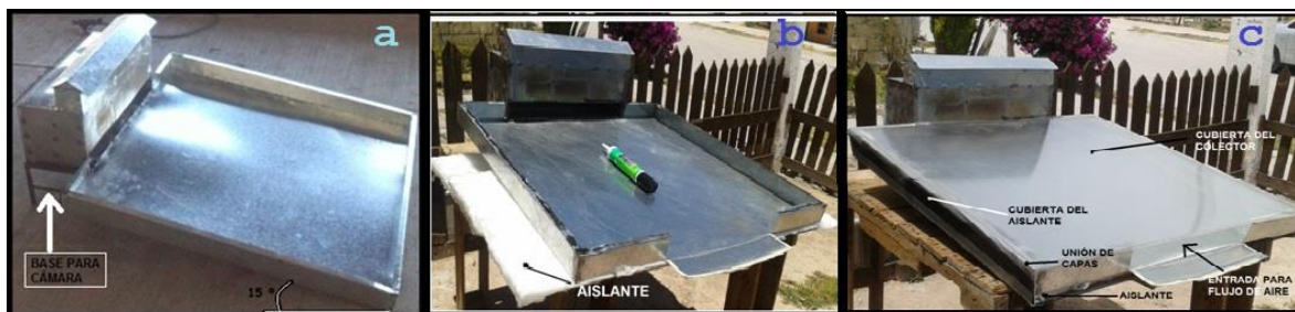
Fig. 1 a) Estructura de acero inoxidable, b) Cubierta aislante, c) Cubierta colector de calor
