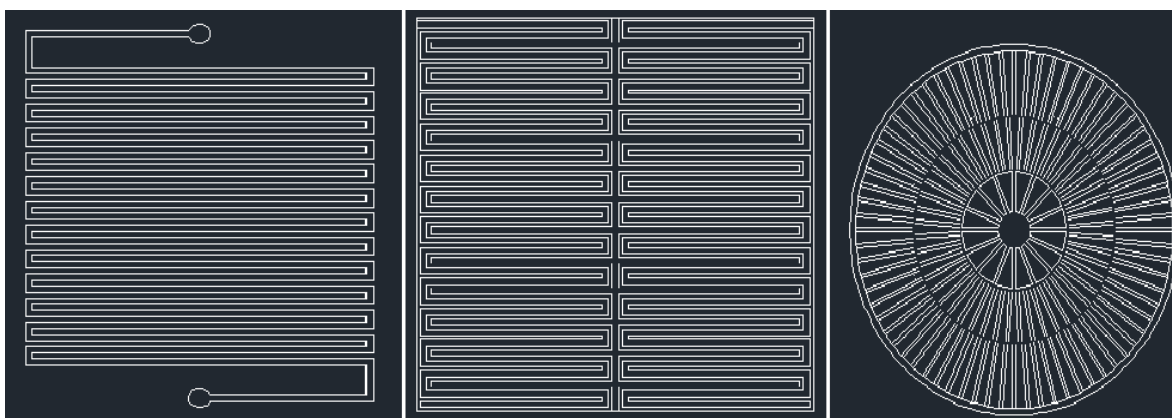
Figura 1. Diferentes geometrías para canales de flujo en placas monopolares
