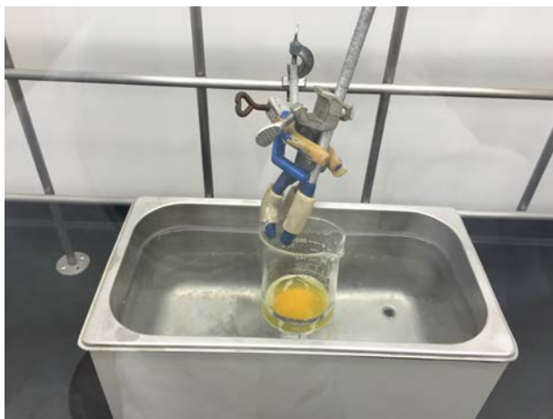
Figura 2. Disolución en un baño de ultrasonido. [4]
