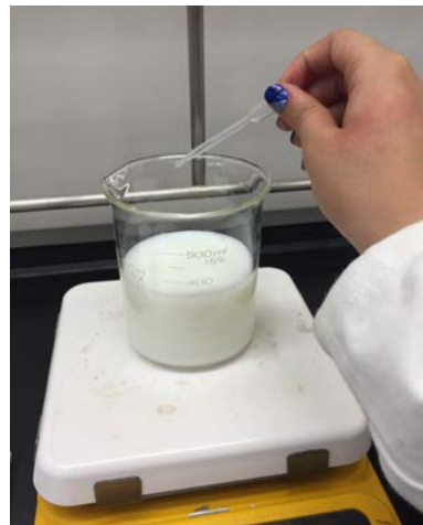
Figura 1. Proceso de goteo del TEOS a la disolución de la titania en isopropanol. [4]
