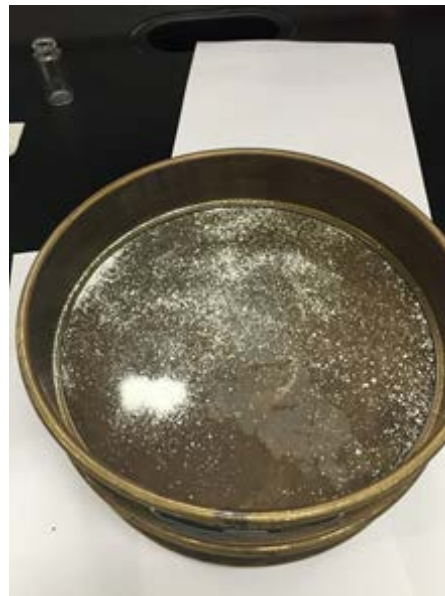
Figura 3. Proceso de tamizado para obtener un polvo fino. [4]
