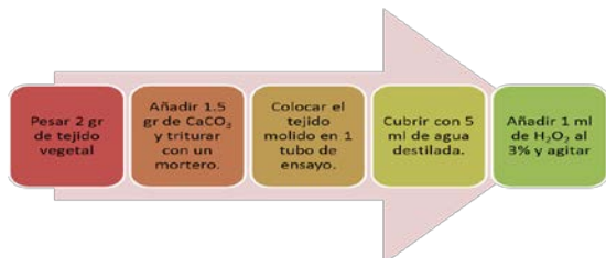
IMAGEN 3: Pasos para la prueba de la peroxidasa [7]
